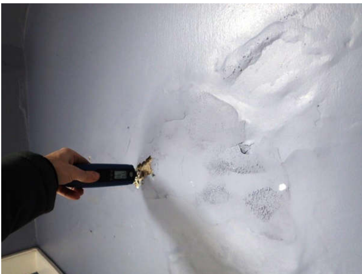
Figur 52 Trapperummet mod øst. Opfugtet murværk med løst puds (ca. 97 ud af 100 digits -vådt). Indikation på indtrængende nedbør.
