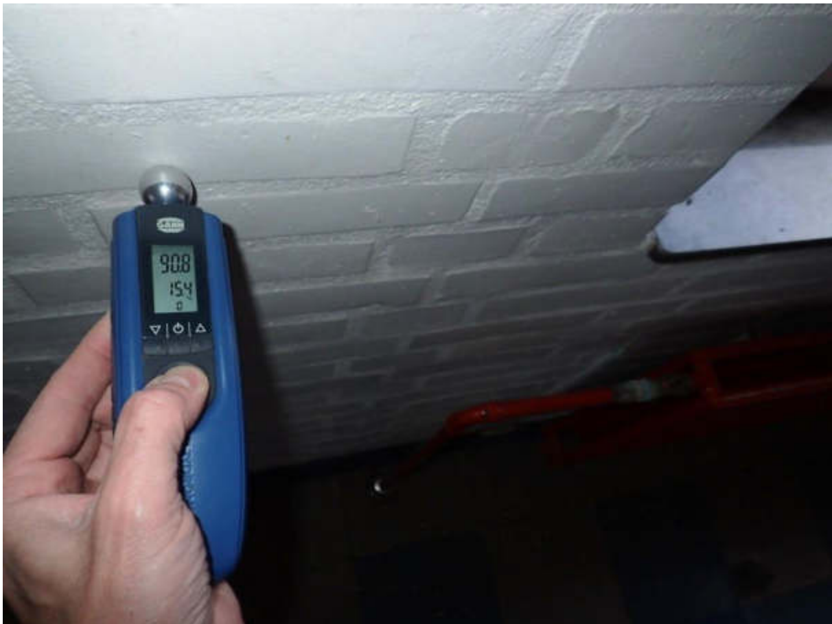
Figur 97 Gangen i stueplan. Forhøjede fugtniveauer registreret adskillige steder i ydervæg (ca. 90 ud af 100 digits -vådt).
