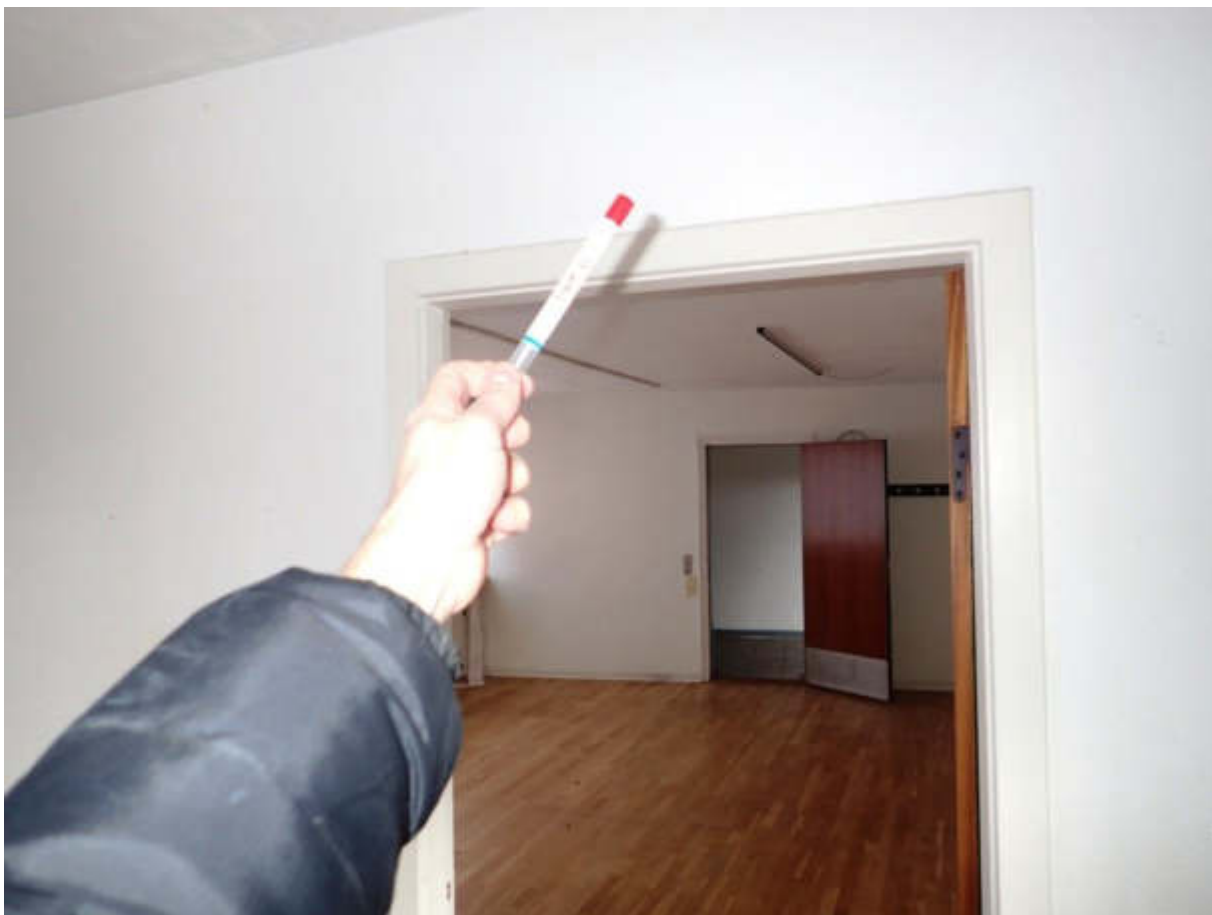
Figur 21 Mellembygning med kontorer. DNA-prøve 3 blev udtaget på overside dørgerigt på dør mellem kontorer.
