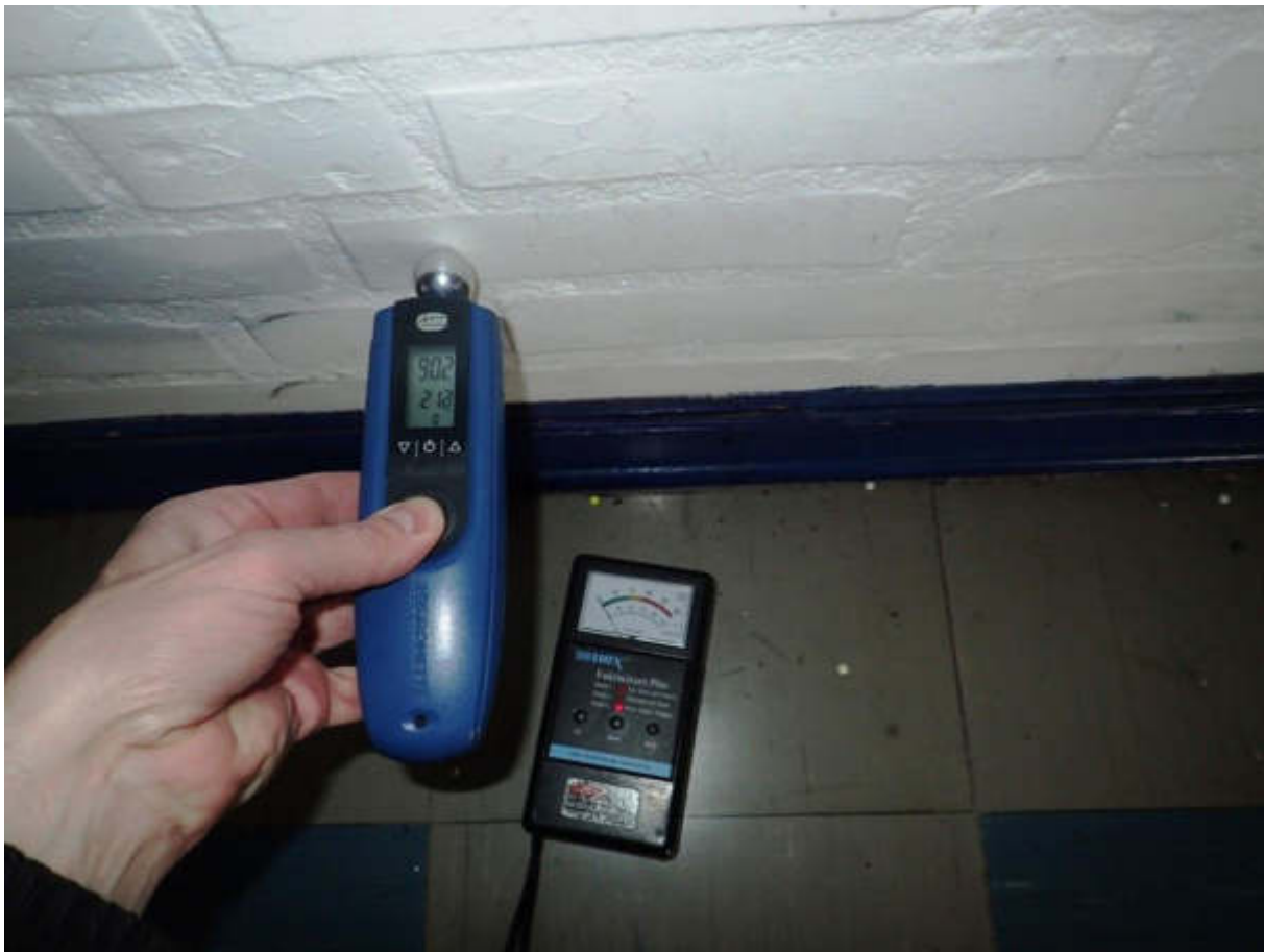
Figur 95 Gangen i stueplan. Forhøjede fugtniveauer registreret adskillige steder i ydervæg (ca. 90 ud af 100 digits -vådt).
