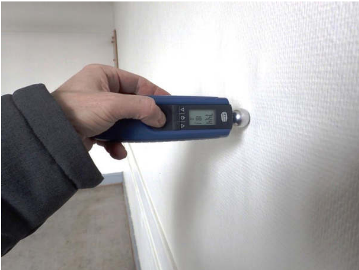
Figur 55 1.sal. Klasseværelse mod sydøst. Forhøjede fugtniveauer registreret i bygningen randzoner (her ca. 74 ud af 100 digits -meget fugtigt).
