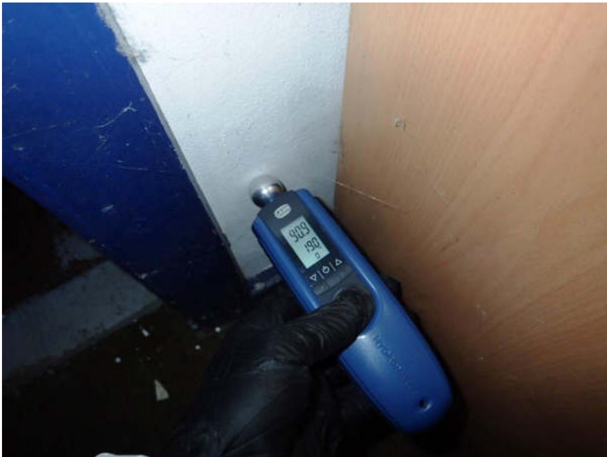
Figur 35 Kontor i kælderen. Høje fugtniveauer registreret i vægge (ca. 90 ud af 100 digits -vådt).
