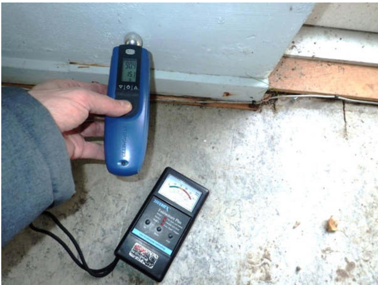
Figur 30 Facade mod nord. Forhøjede fugtniveauer registreret i randzonen ved ydervæg (ca. 90 ud af 100 digits -vådt).
